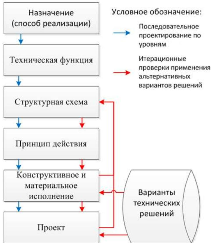
Рис. 2 Схема алгоритма подбора ОПР при описании структуры объекта
